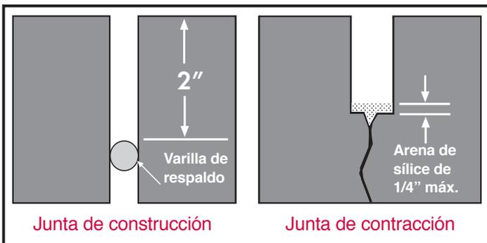
No use varilla de respaldo comprimible en juntas de contracción/control de corte con sierra menores a 2" de profundidad. La varilla comprimible puede usarse como base en juntas de construcción si se coloca a 2" debajo de la superficie del piso.
